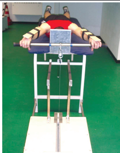
Figura n°3 - Shoulder test: il soggetto solleva la barra, collegata all'encoder, verso l'alto sino al raggiungimento del massimo ROM dell'articolazione della spalla. L'encoder misura in millimetri la flessibilità muscolo-tendinea del cingolo scapolo-omeroale raggiunta.
