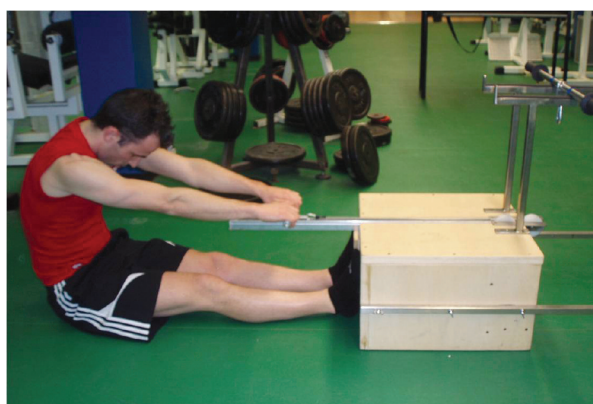
Figura n°1 - Sit and reach box: posizionamento dell'encoder nella parte posteriore del box e sistema a doppia carrucola per lo scorrimento del cavo.
