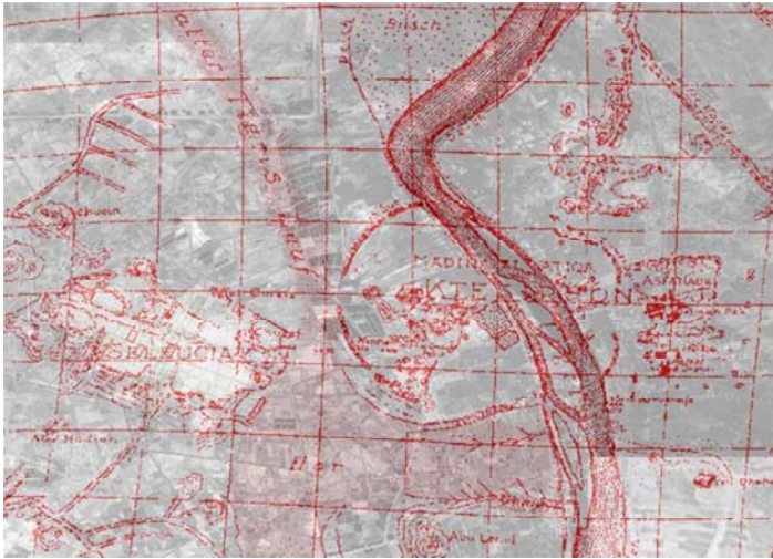
Fig. 3 - Estratto di una delle due piante topografiche di Walter Bachmann (Reuther 1930, fig. 1) georeferenziata col procedimento del rubber sheeting e trasformazione polinomiale su un'immagine satellitare WW2, 2012 (© Digital Globe), con il corso del paleoalveo del Tigri (elaborata da Cristina Bonfanti e Filiberto Chiabrando)
