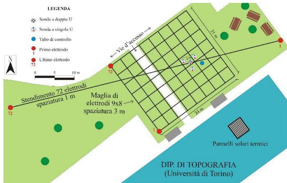
**Fig. 8** – Schematizzazione delle indagini geoelettriche eseguite in sito.
