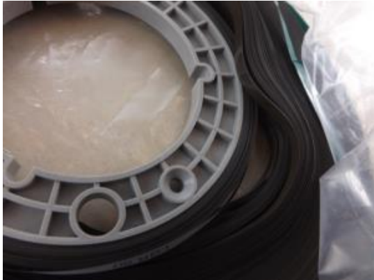
Figura 3. Nastro magnetico soggetto a fenomeni di windowing . Si osservi come il centro della flangia sia completamente fuori asse rispetto al piano di avvolgimento.
