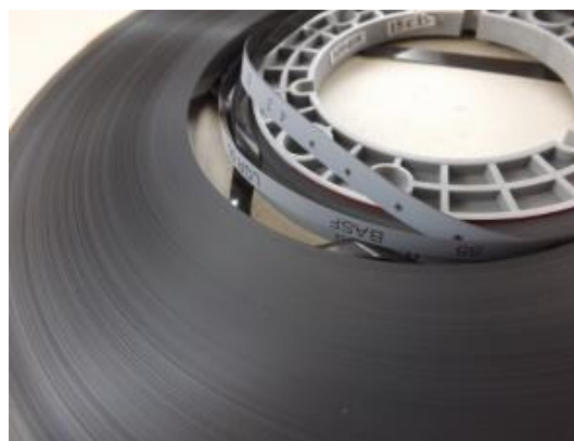
Figura 2. Esempio di distacco del nastro magnetico dalla flangia centrale.
