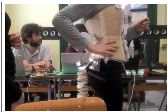
Figure 1. Test del prototipo da défilé . Sullo sfondo, Beagle Bone Black+Bela prima di essere alloggiati nel corpetto.
