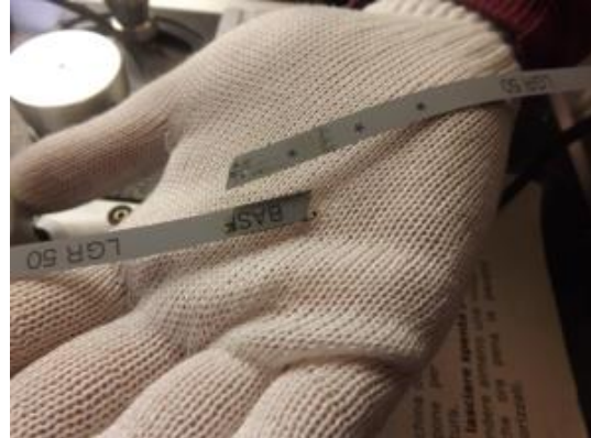
Figura 5. Punto di giunta soggetto a rottura. Sulla superficie del nastro si osserva la presenza di residui di colla.
