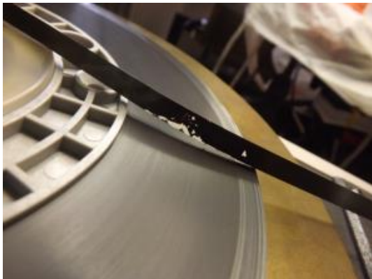
Figura 4. Nastro soggetto a distacco della pasta magnetica.
