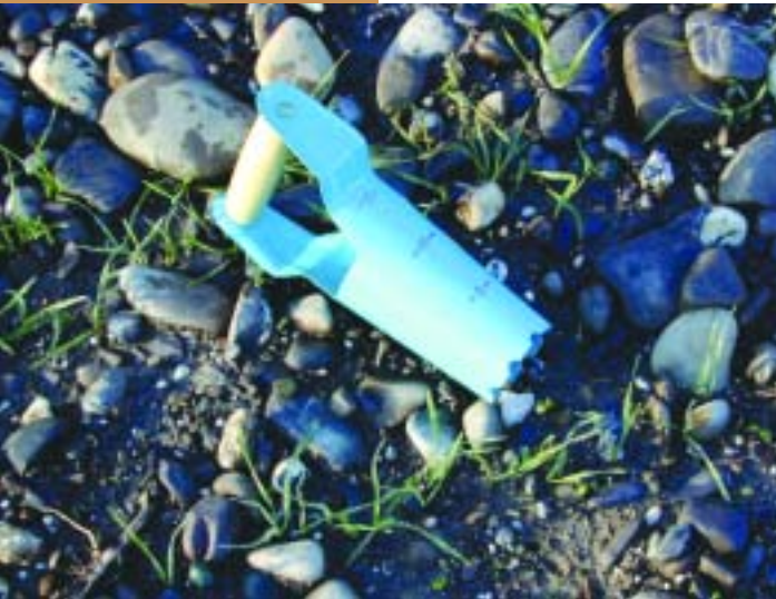
Figura 10 – Un semplice piantabulbi può essere utilizzato come carotatore
