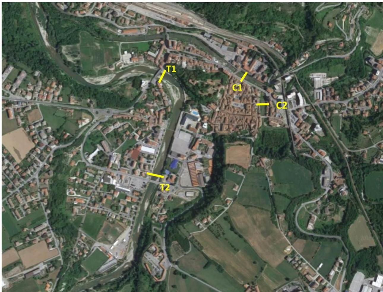
*Figura 5 – Ubicazione delle 4 sezioni su cui è stata valutata la pericolosità idrologica della Città di Ceva: le sezioni T1 e T2 sul Fiume Tanaro e le sezioni C1 e C2 sul Torrente Cevetta.*
