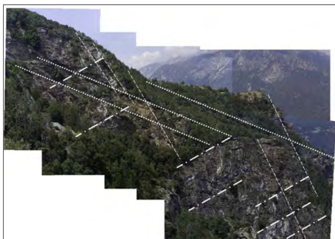
FIGURA 6. Fotocomposizione della parete ad N del canale oggetto della caduta massi: sono evidenziate almeno 3 famiglie di discontinuità a elevata persistenza con una orientazione reciproca congrua alla formazione di grossi prismi di roccia cinematicamente instabili.
