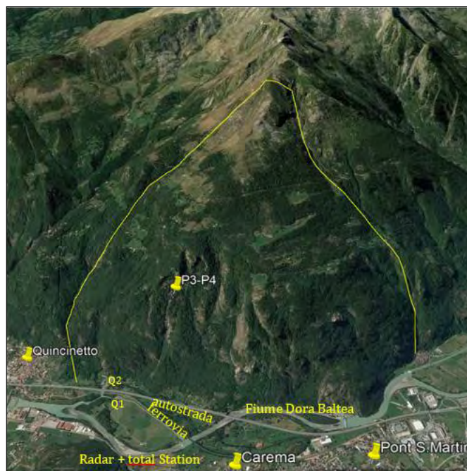
FIGURA 1. La zona in frana, indicata con il segnalino P3-P4, si inserisce in un contesto più ampio (linea gialla) a dubbia stabilità. Sono individuati anche i target strategici potenzialmente a rischio: l'autostrada, la ferrovia, il fiume e due centrali idroelettriche (Q1, Q2). Sono evidenziati anche i paesi di Quincinetto, Carema e di Pont Saint Martin (quest'ultimo in Valle d'Aosta) e l'area in cui sono stati posizionati la stazione totale ed il radar terrestre che monitorano il settore di frana più attivo (P3/P4).
