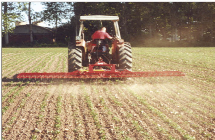
Negli ordinamenti produttivi biologici, nei quali non è consentito l'uso di prodotti chimici di sintesi, i mezzi meccanici (es. strigliatura) rappresentano un valido strumento per la lotta alle malerbe.
