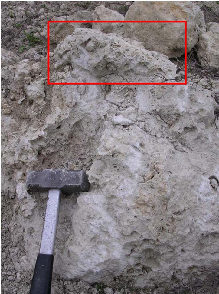
Figura 9: particolare di un blocco di calcari vacuolari, nel riquadro in rosso si possono osservare le tipiche cavità prismatiche legate alla dissoluzione di cristalli di gesso.
