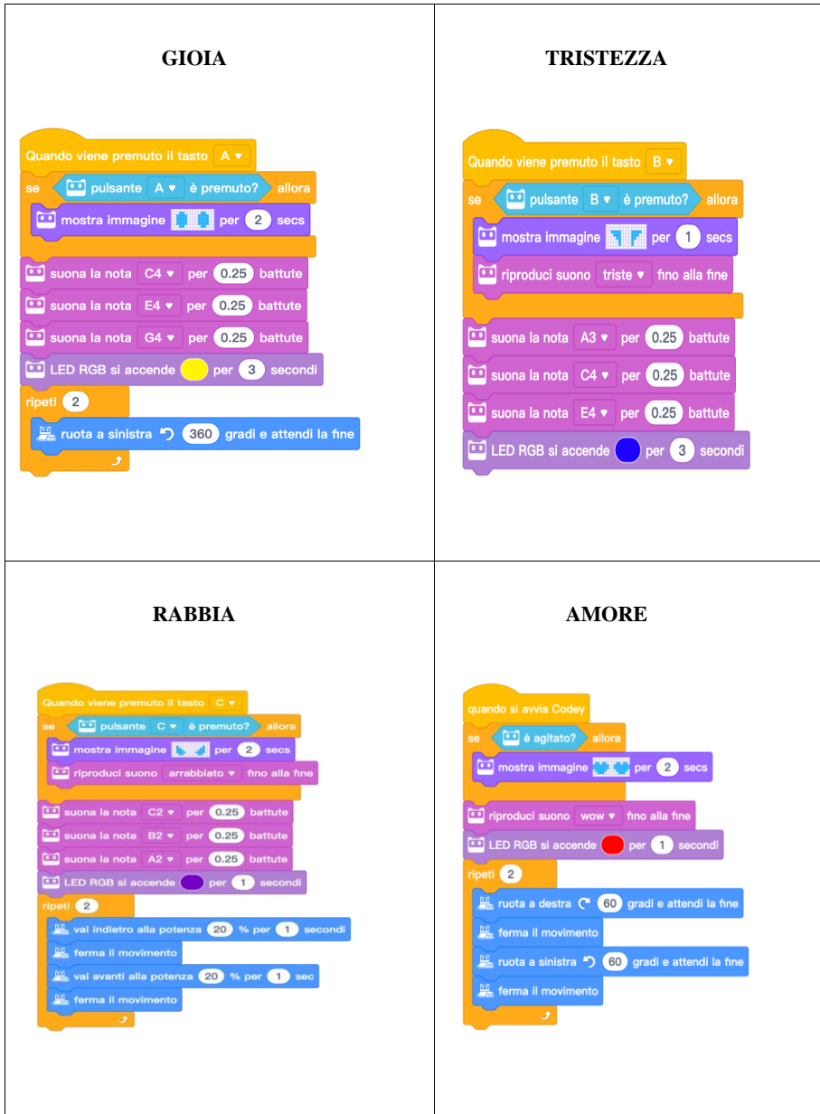
Figura n. 2: programmazione delle emozioni realizzata con linguaggio mBlock
