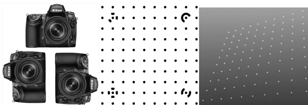
Fig.1-2-3: Posizione della camera per la calibrazione; griglia di calibrazione di Photomodeler e griglia individuata dal software
