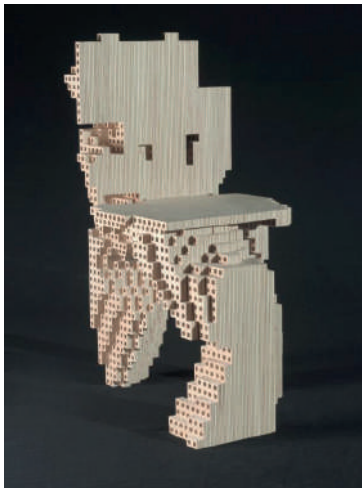
Image 3. EZCT Architecture & Design Research « Modèle test multi chargement “Bolivar” — 320 après 320 générations (32 000 évaluations structurelles) ». Prototype de la série « Computational chair design using genetic algorithms » 20 .
