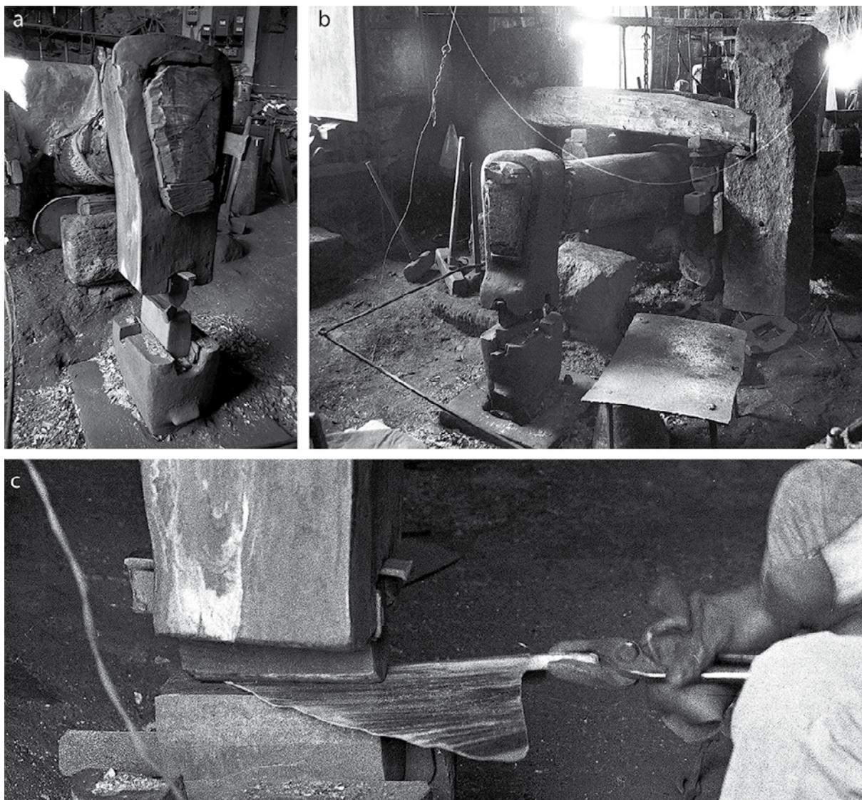
*Figura 30. Particolari: a. testa di maglio; b. struttura di un maglio a testa d'asino o d'ariete; c. della sua azione battente in una fucina della Val Camonica nel bresciano (foto Roberto Prediali).*
