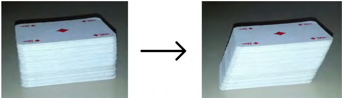
Figura 2. Deformazione di taglio di un mazzo di carte
