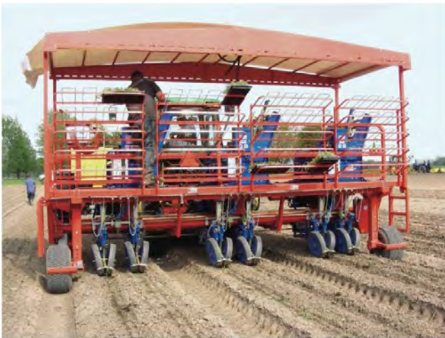
Figura 3. Macchina trapiantatrice (sinistra) e barbatelle di vite (destra)
