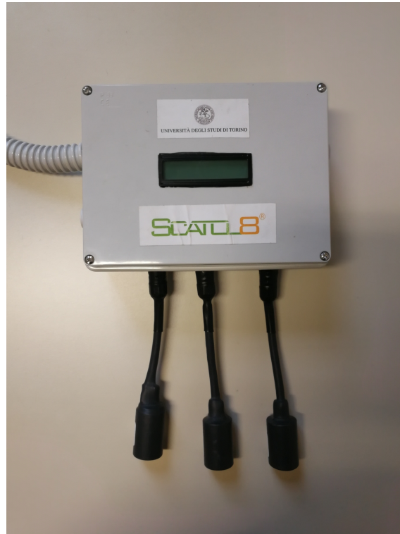
Figura 10.21: I sensori di gas sono stati scelti in base ai propellenti utilizzati per la verniciatura. (fonte interna)
