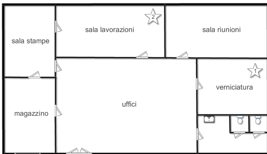
Figura 10.20: Le aree maggiormente critiche, entrambe collocate al primo piano, sono il locale verniciatura per la qualità dell'aria e l'area lavorazioni a causa del rumore (fonte interna)
