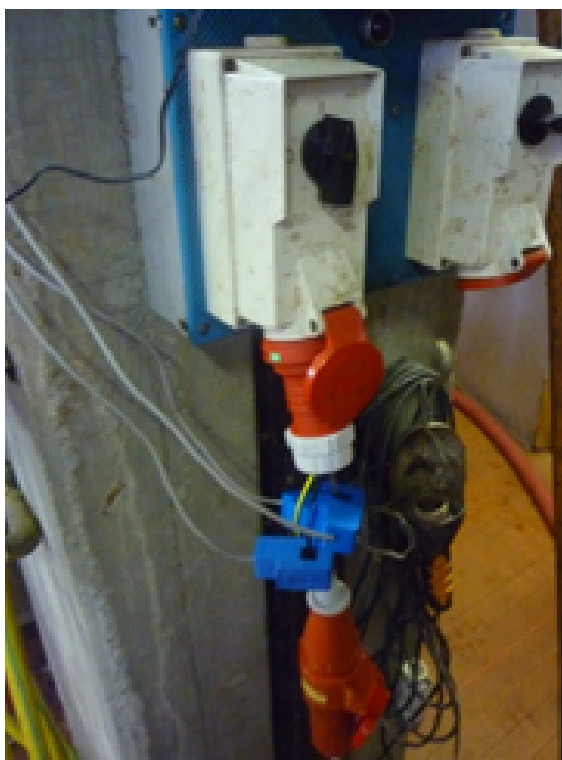
Figura 10.5: Le pinze amperometriche utilizzate per il monitoraggio dei consumi elettrici della pompa dell'acqua (fonte interna)
