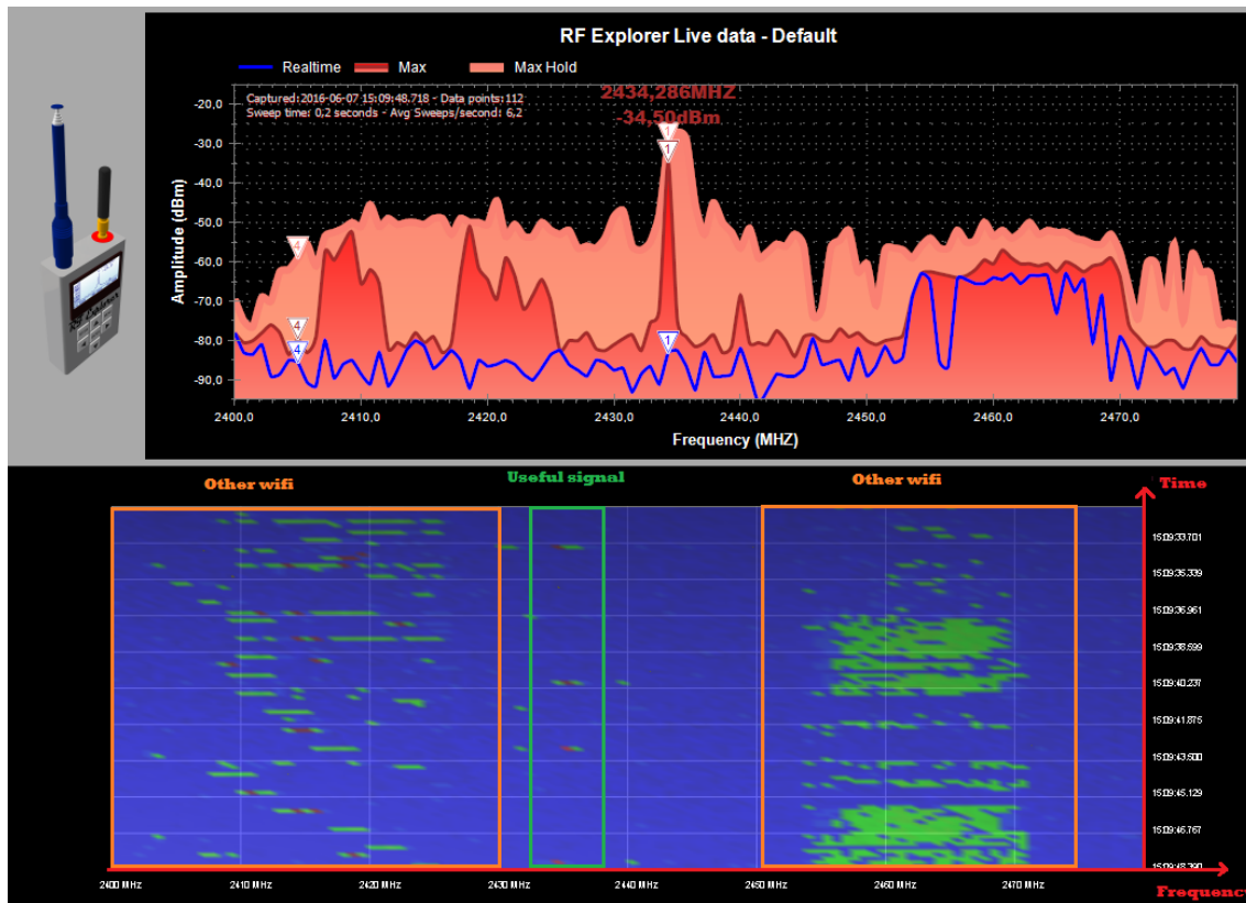
Figura 7.17: Tramite un analizzatore di spettro si è studiato come ridurre le interferenze dovute ad altre antenne attive nell'edificio (fonte interna)
