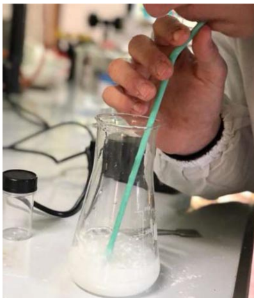
Figura 3. Da anidride carbonica a carbonato di calcio
