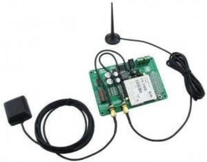
Figura 4. Módulo GSM/GPRS GM862 Telit.
