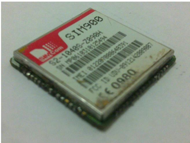
Figura 3. Módulo GPRS SIM900.
