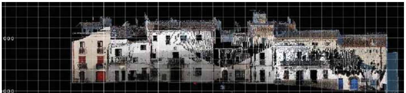
Remise en place d'un tronçon de façades à l'aide d'un scanner préalablement à leur inventaire et à leur catalogue
