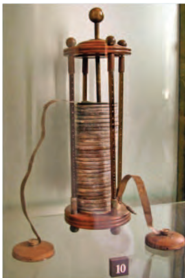
Figura 1. La pila di Volta (1799) (versione Rame/Zinco) in esposizione presso il Tempio Voltiano, Como
