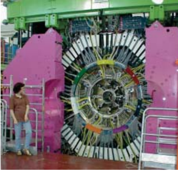
Fig. 6. – Vista frontale dell'apparato sperimentale FINUDA durante la fase di installazione dei rivelatori: sono presenti gli scintillatori esterni, i tubi a straw e le camere a deriva.
