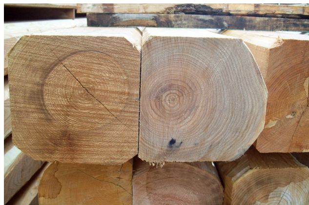
Figura 2. Travi di castagno "Uso Fiume". Gli assortimenti vengono squadrati e successivamente piallati a mano con smusso fino alla punta, mantenendo una sezione costante. A sinistra, lavorazione effettuata con pialla a mano di travi in castagno "Uso Fiume" e, a destra, particolare di alcune sezioni con smusso.
