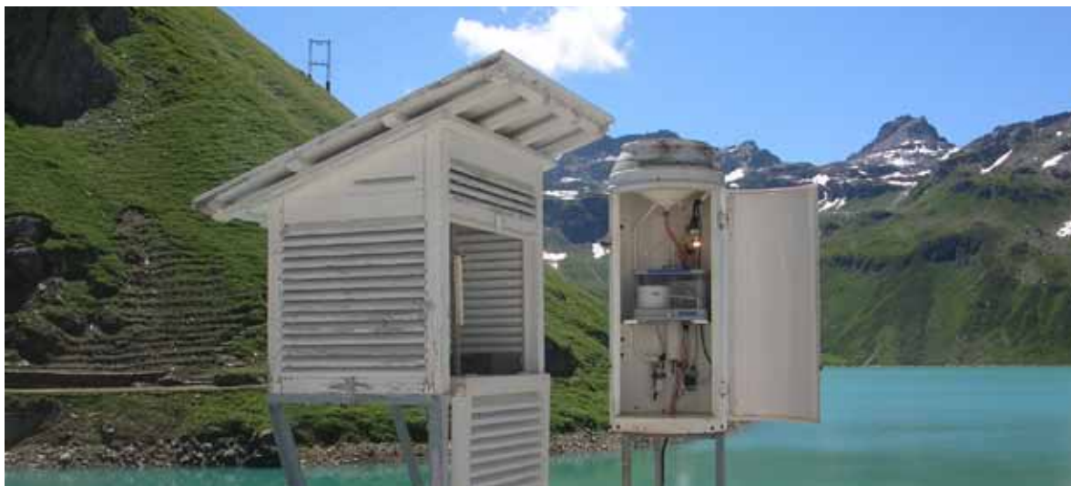
Fig. 2.3 Capannina meteorologica con termometro a massima e minima (a mercurio) e pluviografo presso la stazione manuale del Lago Vannino.
