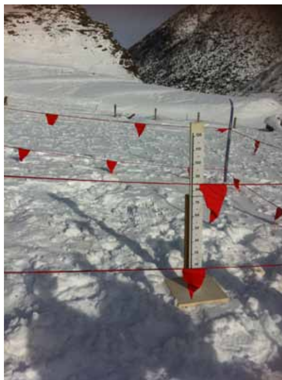
Fig. 2.5 Tavoletta per misura della neve fresca (HN) con asta graduata.
