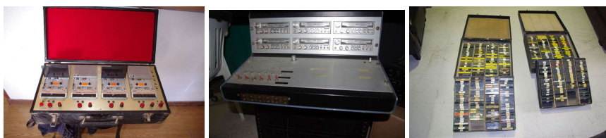
Figura 14 – I Lettore di basette 4-deck risalente ai primi anni ‘70, costruito da Mario Lupi per la Anzellotti Sound Effects (si tratta di un modello molto simile ai primi prototipi costruiti). II. Lettore di basette 6-deck risalente agli anni ’80 costruito per conto di Italo Cameracanna. III: Due valigie del più vasto repertorio di ambienti ritrascritti su nastro da \frac{1}{8} ”, appartenute a Renato Marinelli (per gentile concessione di I: Massimo e Luciano Anzellotti; II: Italo Cameracanna, III: Marco e Massimo Marinelli).
