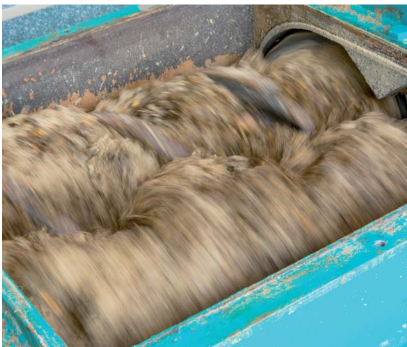
Figura 1. Coclee dell'estrusore in azione.
