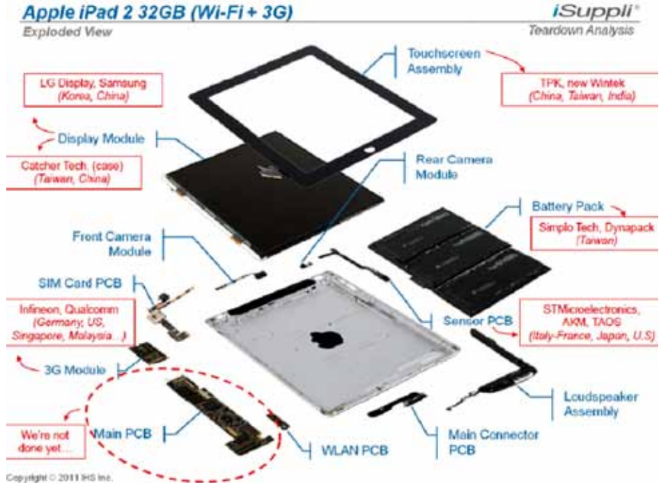
Figura 1. Principali componenti di un iPad 2
