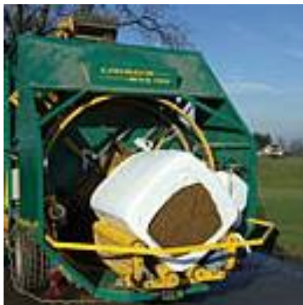
Figura 5 - Esempio di insilatrice di balloni a punto fisso da utilizzare a bordo campo o nei centri aziendali
