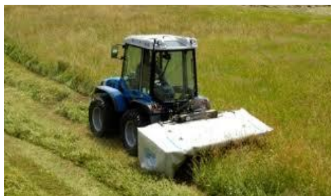
Figura 2 – A sn trattrice per ambienti montani derivata da una macchina convenzionale ricorrendo alla retroversione e alla gemellatura delle ruote; a ds trattrice con ruote isodiametriche in versione retroversa in fase di sfalcio
