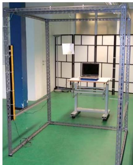
**Figura 3 – Struttura metallica per la verticalizzazione dell'Optojump.**
