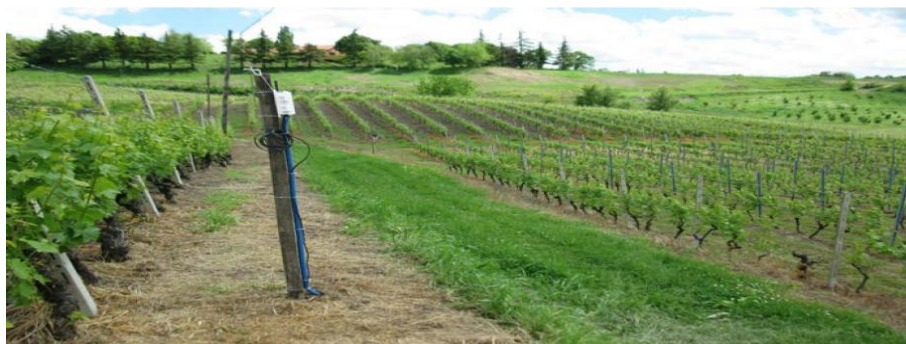
Fig. 5 – La stazione di monitoraggio meteo-idrologico installata presso l’azienda vitivinicola di Cascina Gilli di Castelnuovo Don Bosco (AT). In primo piano la centralina per la registrazione dell’umidità del terreno a diverse profondità; sullo sfondo la centralina meteorologica.
