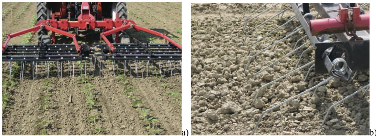
**Figura 8. a) Erpice strigliatore durante un trattamento su girasole; b) particolare dei denti elastici.**
