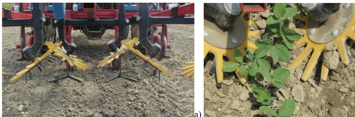
**Figura 6. a) Finger-weeder: sono visibili gli elementi sarchianti a “zampa d’oca” e i piattelli con le dita gommate; b) finger-weeder durante un trattamento su soia.**
