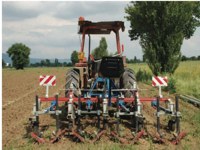
**Figura 2. Attrezzatura detta “Finger weeder” in grado di operare nelle immediate vicinanze dei filari della coltura.**
