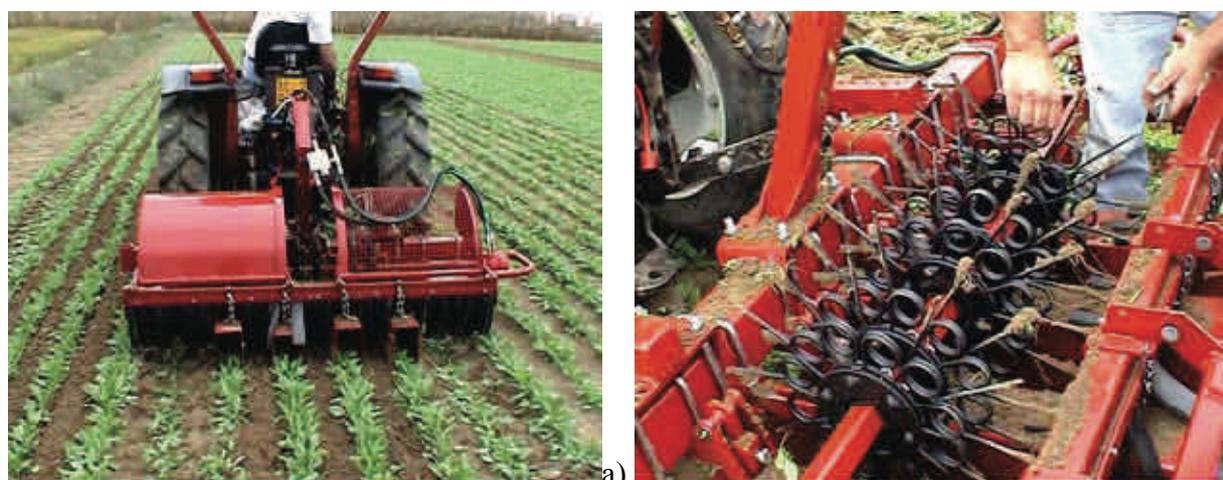
**Figura 4. a) Sarchia-separatrice su spinacio (interfile di 25 cm): sono visibili i carter a protezione della coltura; b) fili di acciaio flessibili montati su flange rotanti a mo' di spazzola (da Tei et al., 2002a).**
