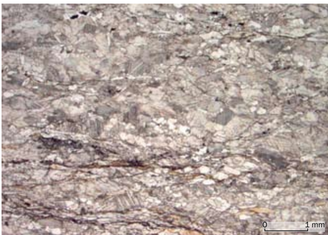
3. Immagini in microscopia ottica rappresentative del marmo impuro foliato a silicati della Zona Piemontese Interna, stele 35, sez. sott. C16; a sinistra solo polarizzatore, a destra polarizzatori incrociati. (M. Serra)
