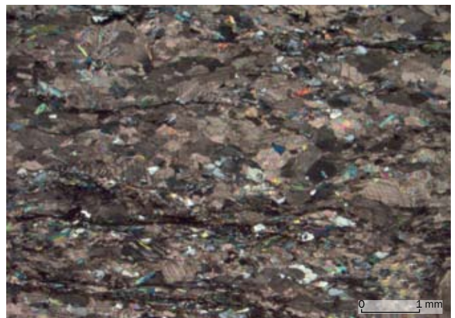
3. Immagini in microscopia ottica rappresentative del marmo impuro foliato a silicati della Zona Piemontese Interna, stele 35, sez. sott. C16; a sinistra solo polarizzatore, a destra polarizzatori incrociati. (M. Serra)
