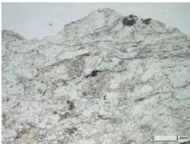
7. A sinistra, microfotografia in elettroni retrodiffusi relativa alle miche isolate e caratterizzate da orientazione preferenziale dimensionale. A destra, fotografia in microscopia ottica (polarizzatori incrociati) di un particolare relativo ad un cristallo di albite picilitica. (V. Rubinetto)
