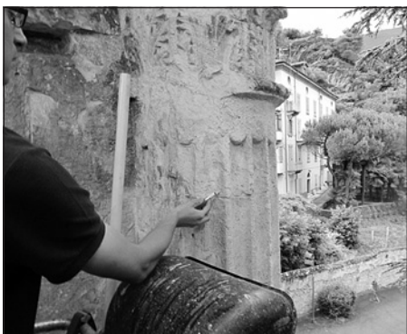
Fig. 3. Fotografia scattata sul lato Est per indicare il punto di campionamento durante la campagna di prelievo effettuata con il cestello. Si notano superfici di diverso colore, dal giallo bruno, al grigio, al rosato (come il punto indicato).
