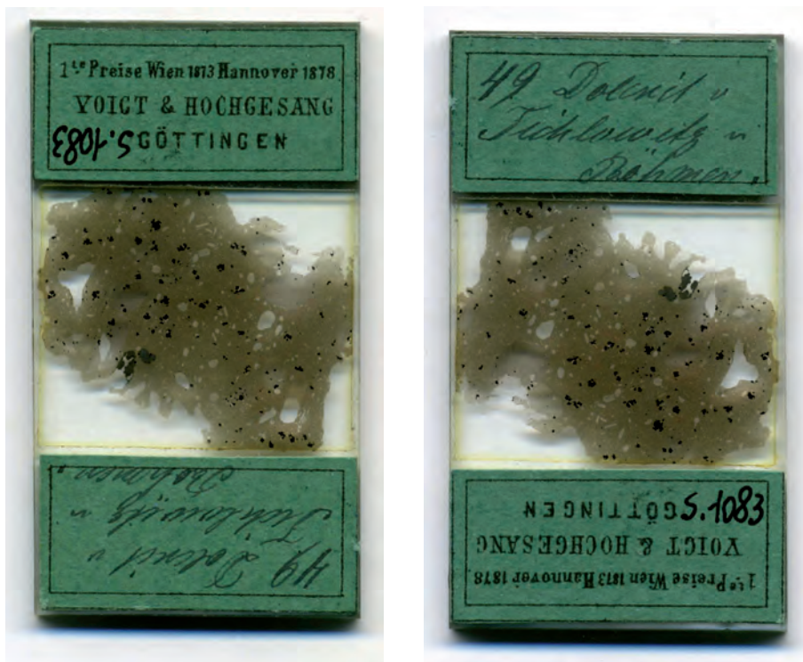
Fig. 1. esempio di sezione sottile: Su ogni sezione sottile da un lato riportato il nome della ditta produttrice e dall'altro sono manoscritti il nome della roccia in esame e il luogo di provenienza scritti a mano .
