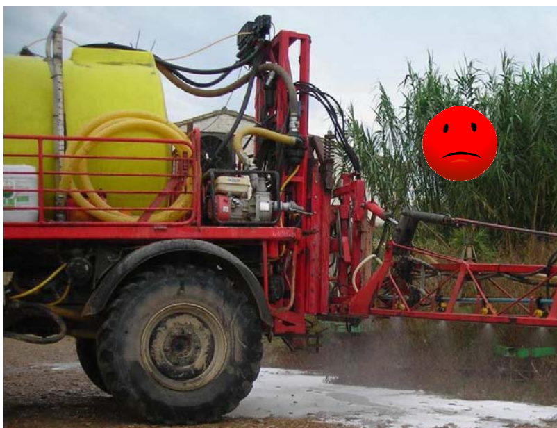
Fig. 71 – Attivare l'erogazione della miscela fitoiatrice quando l'irroratrice è ferma comporta un elevato rischio di inquinamento del suolo e delle acque (foto UPC).
