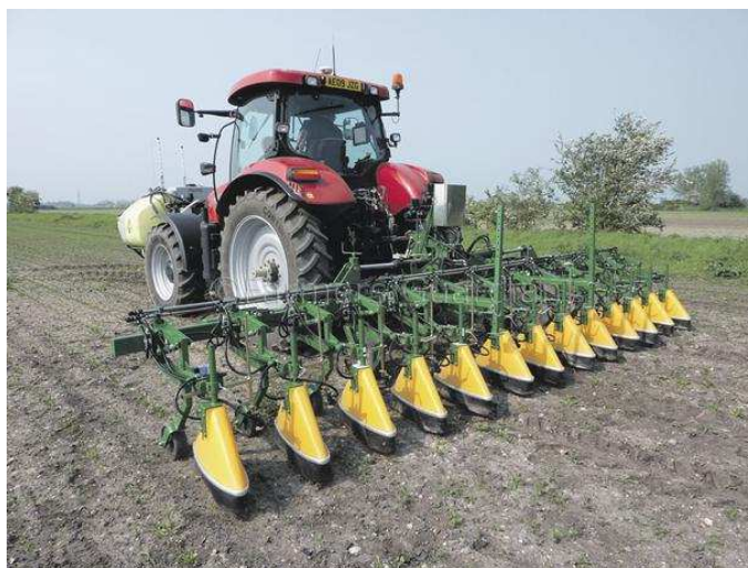
Fig. 160 – Diserbo schermato sulla fila. (foto: www.farmersguardian.com ).
