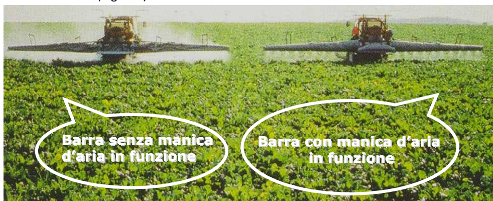
Fig. 156 – Distribuzione senza e con attivazione della manica d'aria.
