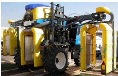
Fig. 164 - Esempi di irroratrici con sistema di recupero del liquido che oltrepassa il filare.
