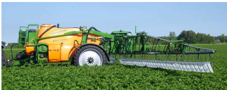
Fig. 158 – Il crop tilter apre la vegetazione per favorire una migliore penetrazione delle gocce (foto: http://www.vibyteknik.se )
