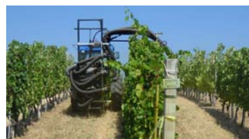
Fig. 183 - irroratrice scavallante semplice
