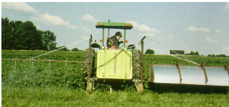
Fig. 157 – Irroratrice con schermatura.
