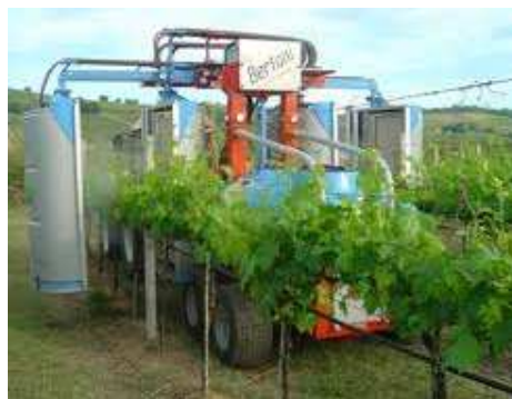
Fig. 164 - Esempi di irroratrici con sistema di recupero del liquido che oltrepassa il filare.
