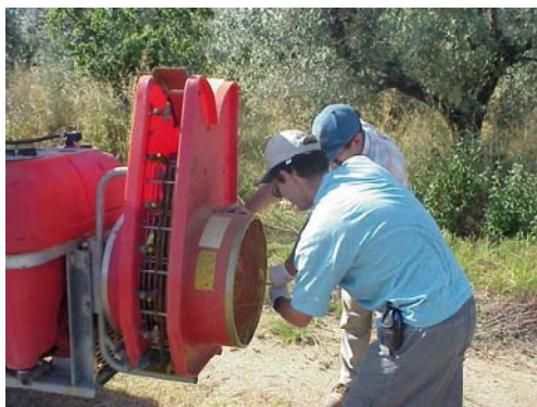
Fig. 149 – Regolazione dell'inclinazione delle pale.
