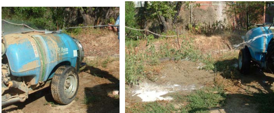
Fig. 2 – Lavaggio irroratrice e inquinamento puntiforme
