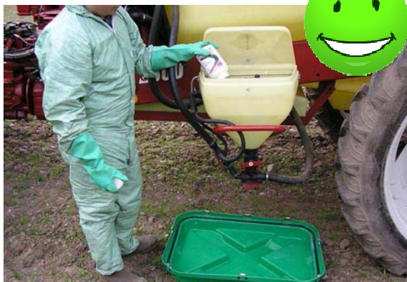
Fig. 61 – Esempio di soluzione atta ad evitare possibili fonti di inquinamento puntiforme durante la preparazione della miscela fitoiatrica (Foto Harper Adams).
