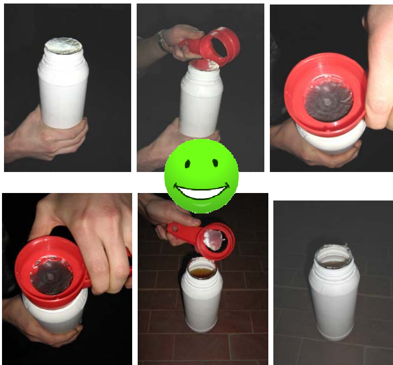
Fig. 60 – Rimozione in sicurezza della linguetta di protezione dei flaconi di fitofarmaci con l'impiego di un apposito taglierino (cutter).
