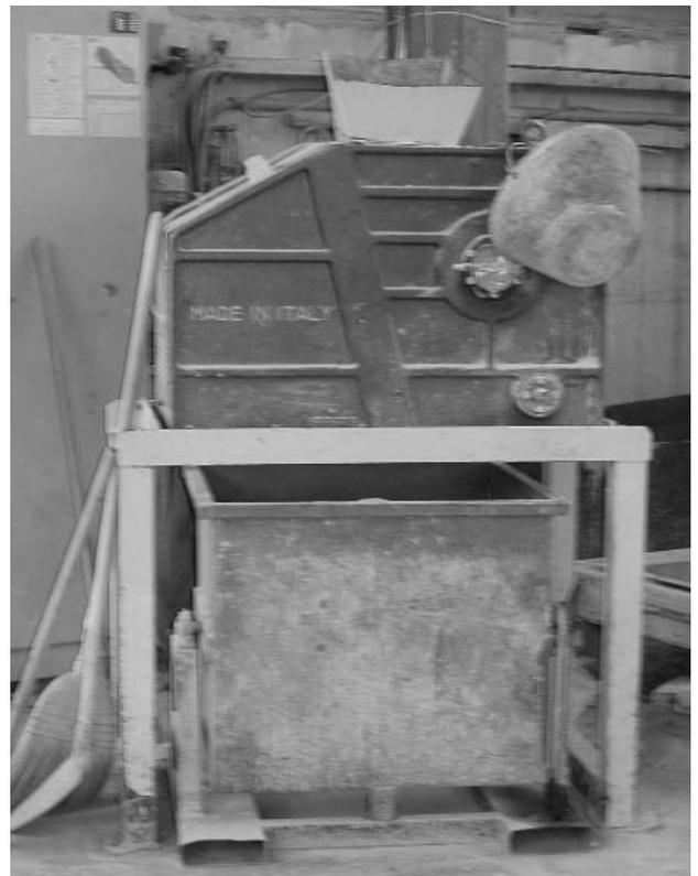
Fig. 3. Cocciame di granito bianco di Montorfano accantonato (sx) per essere frantumato (dx) ed usato quale ghiaietto o quale terra e roccia da scavo.
