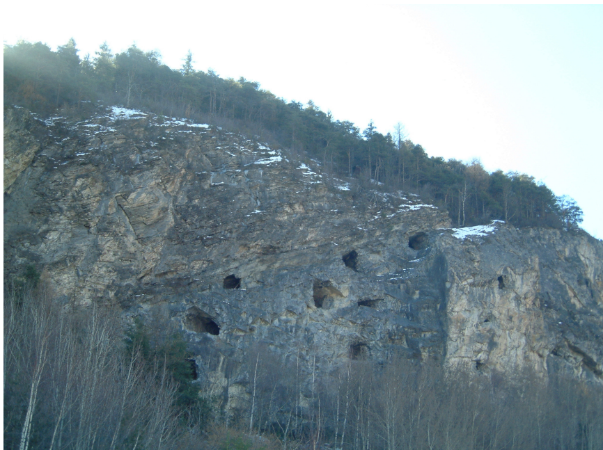
Fig. 18 - Tracce delle coltivazioni entro una bancata di calcari dolomitici in comune di Aymavilles.
