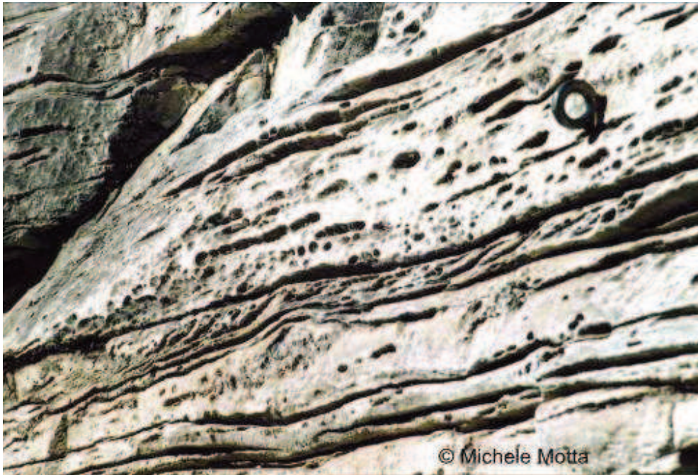
Hollows and grooves, on the more porous parts of a marble (500 m a.s.l., Susa Valley, Western Alps, I). Cariatature e solchi derivanti dalla maggiore corrosione dei livelli più porosi. Marmo dolomitico (Bianco di Foresto). Valle Susa.
