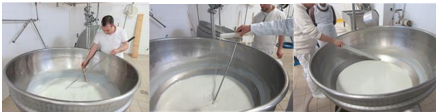
a) Pasteurizzazione lenta b) Aggiunta del caglio vegetale c) Rottura della cagliata con la spada
