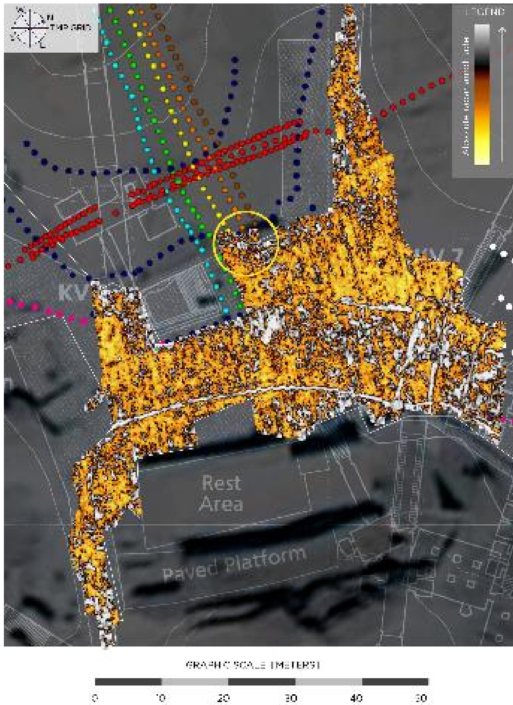
Fig. 13. Mappa GPR rappresentativa (200 MHz) ottenuta proiettando sullo stesso piano tutti i segnali radar riflessi entro 2,5 m di profondità dal p.c. ( overlay GPR analysis technique ). Il cerchio giallo identifica la potenziale area d'interesse rilevata dalle misure GPR, approssimativamente corrispondente alla posizione dell'Anomalia 1. Parametro rappresentato: Absolute Reflection Amplitude
