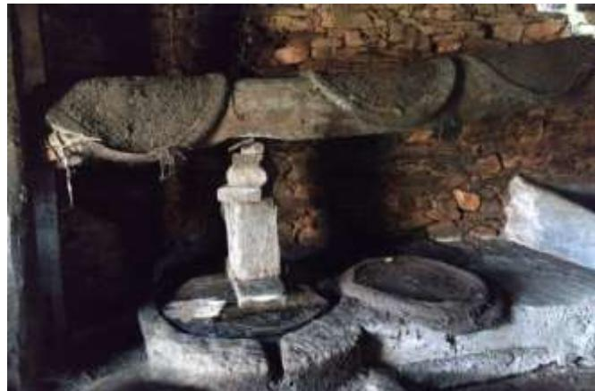
*Figura 8. Detalle de molino de aceitunas para extracción de aceite.*
