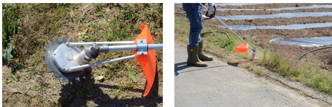
Figura 9. Decespugliatore dotato di testa di taglio reciprocante in azione su un bordo stradale. In questo modello i due dischi sono controrotanti (foto F. Vidotto).
