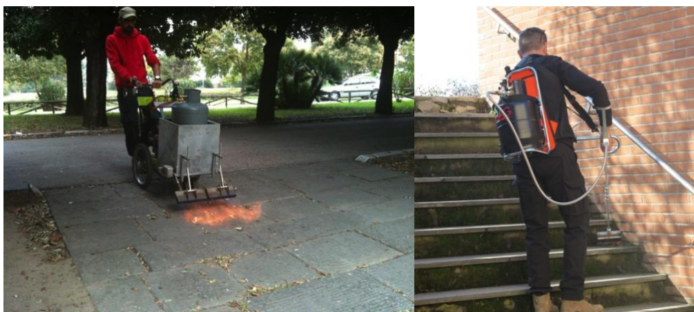
Figura 10. Pirodiserbatrice carrellata per il diserbo di superfici piane pavimentate (sinistra) e modello spalleggiato per l'impiego su piccole superfici (foto F. Vidotto).
