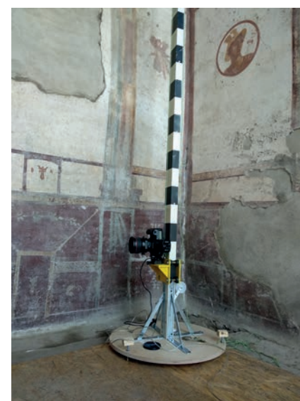
Fig. 3. Il binario verticale a carrello mobile utilizzato per le prese fotografiche delle pitture murali
