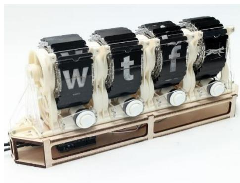
Figura 19. Pantalla de solapas reconstituida con materiales Arduino (DIY)
