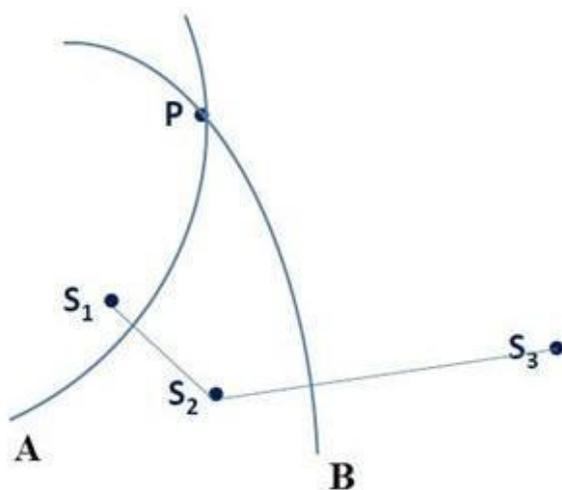
Fig. 3. Schema in cui sono indicate le postazioni di osservazione ( $S_1, S_2$  e  $S_3$ ), i rami a sinistra (A, B) delle le due iperboli, e il loro punto di intersezione P, dove si trova la postazione nemica.
