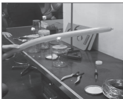
Fig. 3. Verifica del funzionamento della bottiglia di Leida costruita con bicchieri di plastica e carta stagnola.
