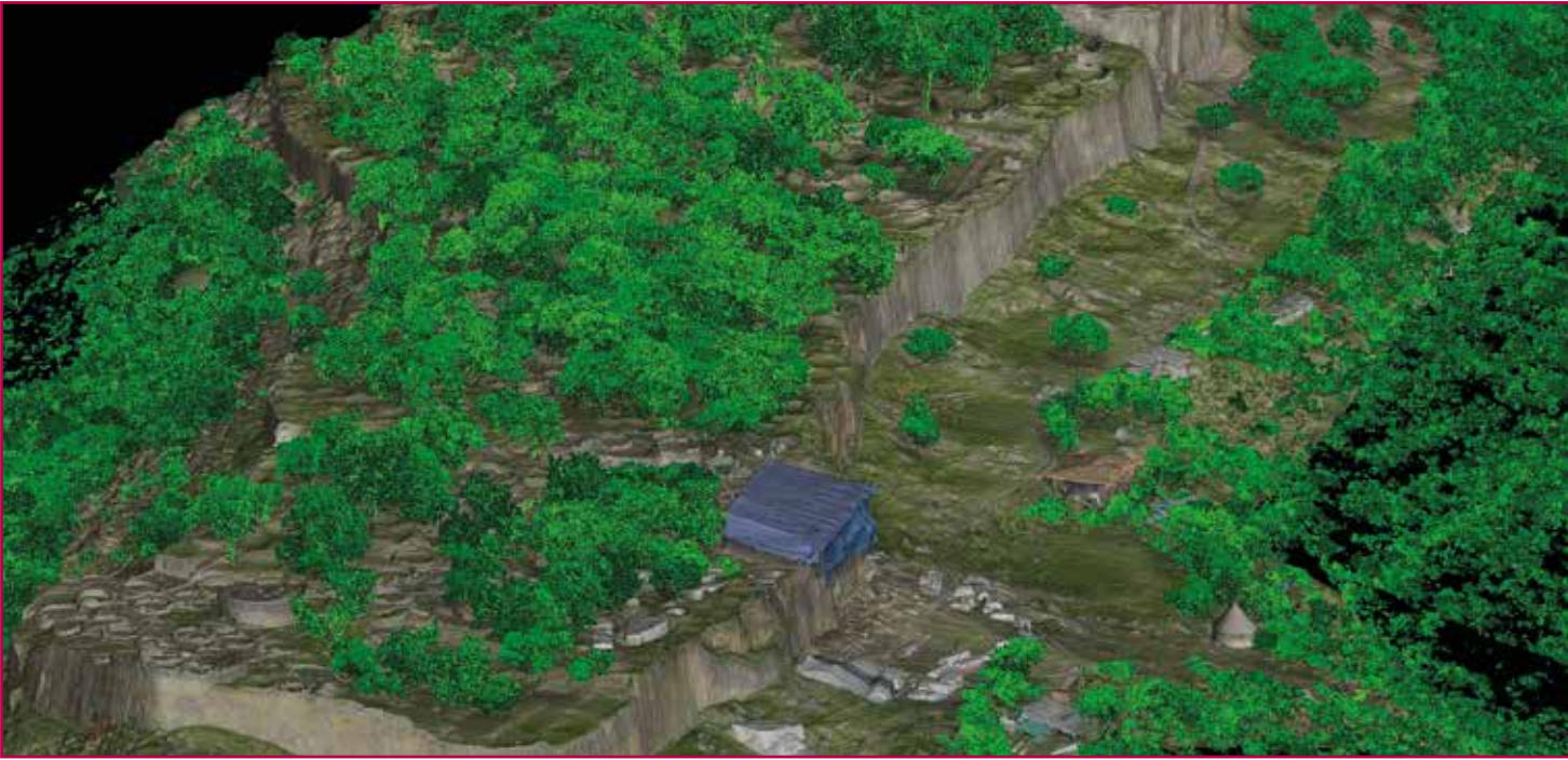
Fig. 5 - Rappresentazione della mesh texturizzata generata a partire dalla nuvola di punti LiDAR, con sovrapposizione del filtraggio della sola vegetazione da LiDAR.
