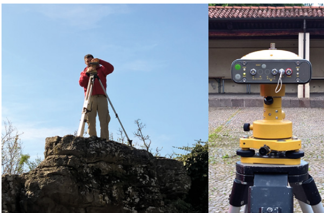
fig. 3 – A sinistra la stazione Master posta sulla parte alta della torre; a destra dettaglio della stazione Master.
