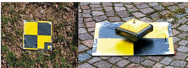
fig. 4 – A sinistra target di metallo dipinto a colori vivaci; a destra target con il ricevitore Rover.
