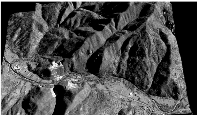
fig. 18 – Inquadrate dell’immagine satellitare ad alta risoluzione Worldview-2 drappeggiata sul Modello Digitale del Terreno (DTM).
