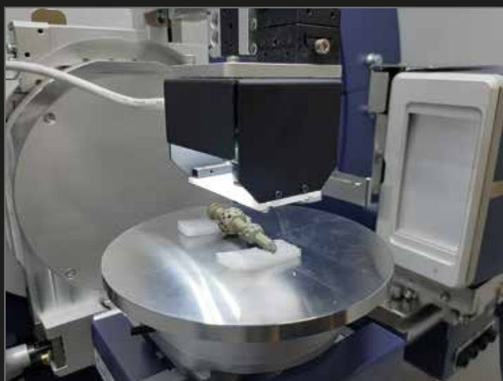
Fig. 4. Analisi \mu -XRD in corso della terminazione di staffa tipo "Palestro" dalla loc. Santo Spirito, Gropello Cairoli (Vigevano, Museo Archeologico Nazionale della Lomellina, inv. 2019.01.112)
