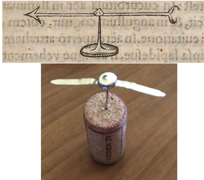
Figura 3.4: A sinistra: versorium di Gilbert, nel De Magnete[36]. A destra: versorium realizzato con materiale povero
