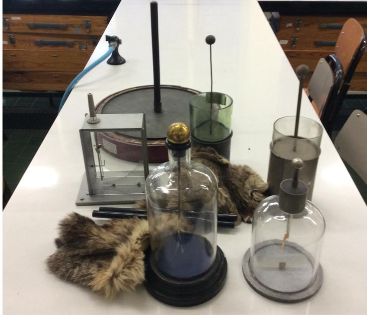
Figura 2.15: Elettroscopi e bottiglie di Leida (laboratorio di fisica del liceo Alfieri)
