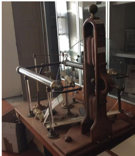
Figura 2.73: Macchina elettrica di Ramsden del liceo Baldessano Roccati di Carmagnola
