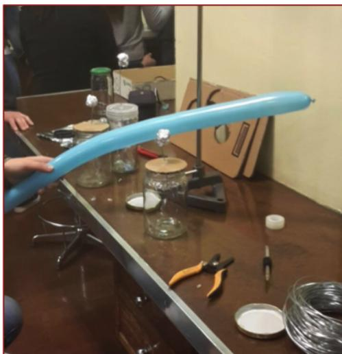
Figura 3.5: Elettroscopio costruito con materiale povero
