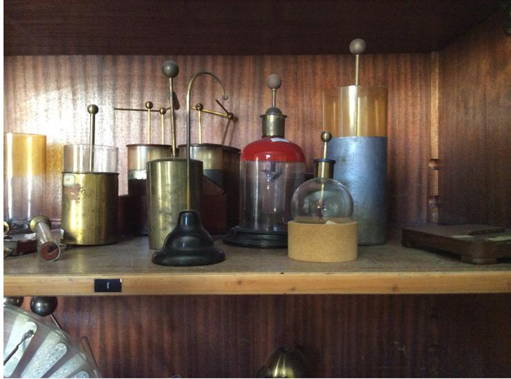
Figura 2.51: Strumenti di elettrostatica: bottiglie di Leida, elettroscopio e pendolino (liceo Arimondi-Eula, Savigliano)
