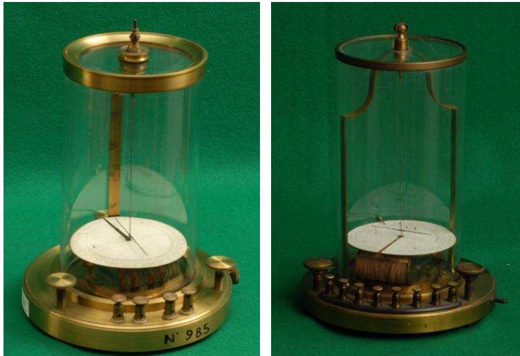
Figura 1.77: Galvanometri differenziali: a sinistra quello realizzato da Gourjon (inv. 534) e a destra quello realizzato da Jest (inv. 535)
