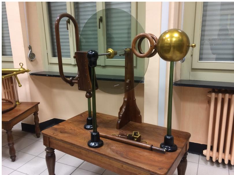
Figura 2.3: Macchina elettrica di Topler-Holtz, Liceo Cavour di Torino
