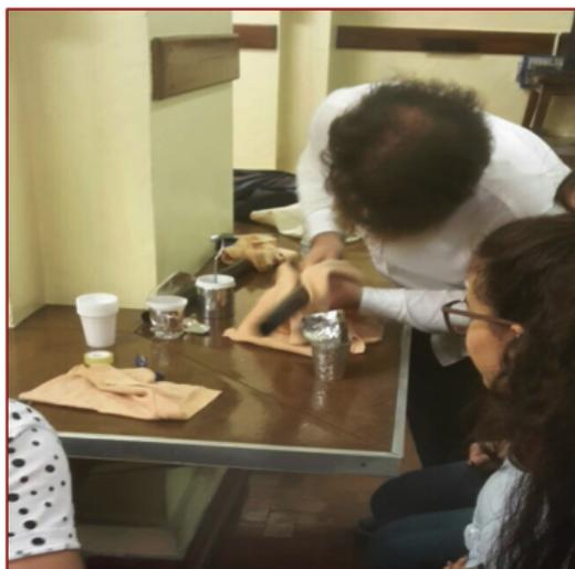
Figura 3.6: Verifica del funzionamento della bottiglia di Leida costruita con bicchieri di plastica e alluminio
